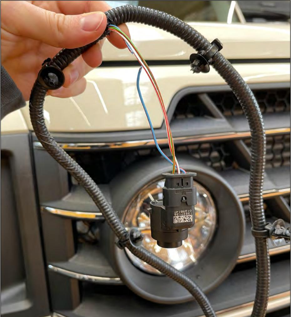
Ummantelung beider mittlerer PDC-Sensoren entfernen.
