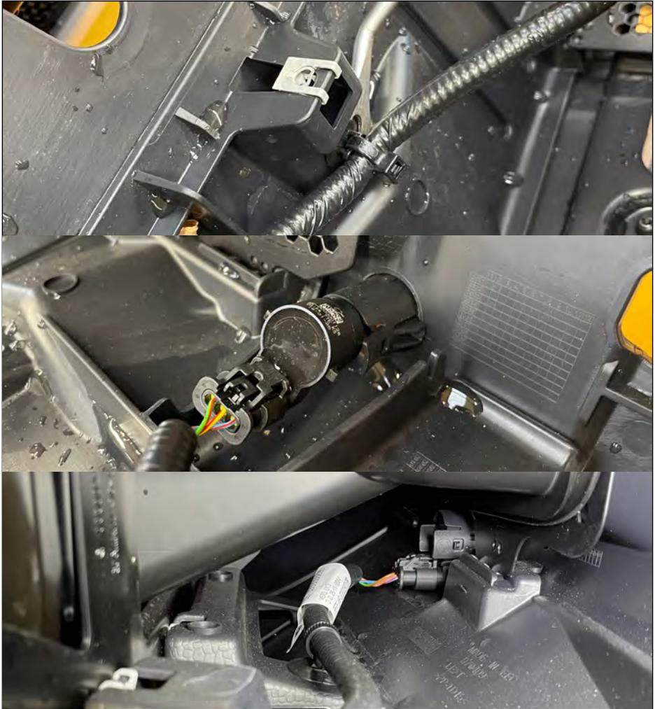
Kabelstrang mit PDC-Sensoren von Mittelteil und Stoßstange vorne links lösen.
