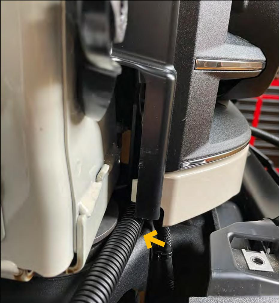
Pluskabel hinter senkrechtes Kabel führen.
