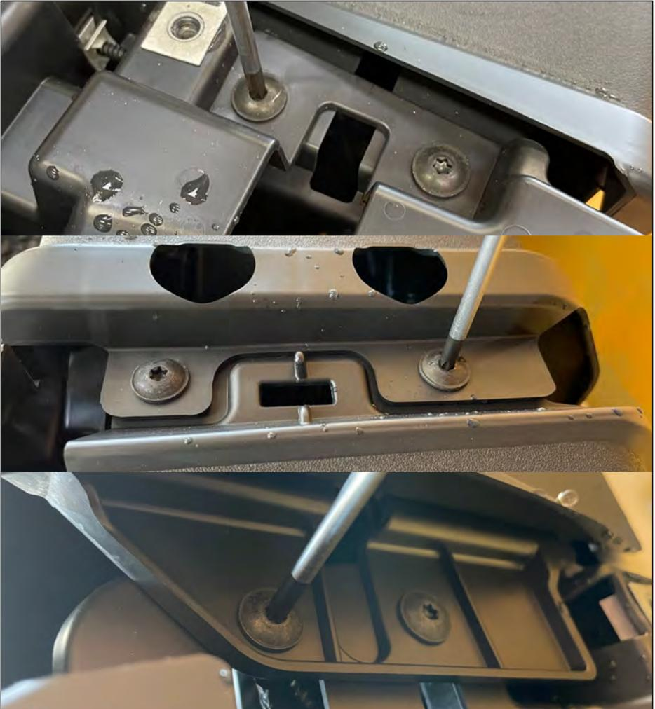
Je 6 Torx Schrauben links und rechts entfernen.
