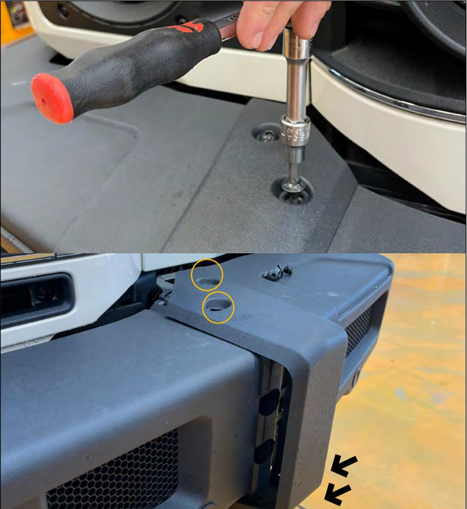
Je 4 Schrauben der Kunststoffhalter rechts und links und Kunststoffhalter entfernen.
