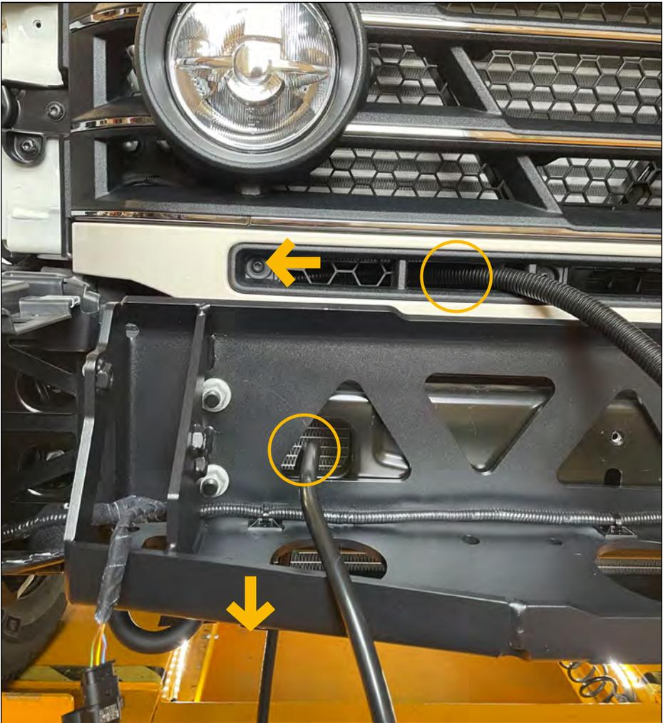
Kabel der Warn Zeon 10 Winde durch die Löcher ziehen. (Verlegung kommt später ab S. 35)
