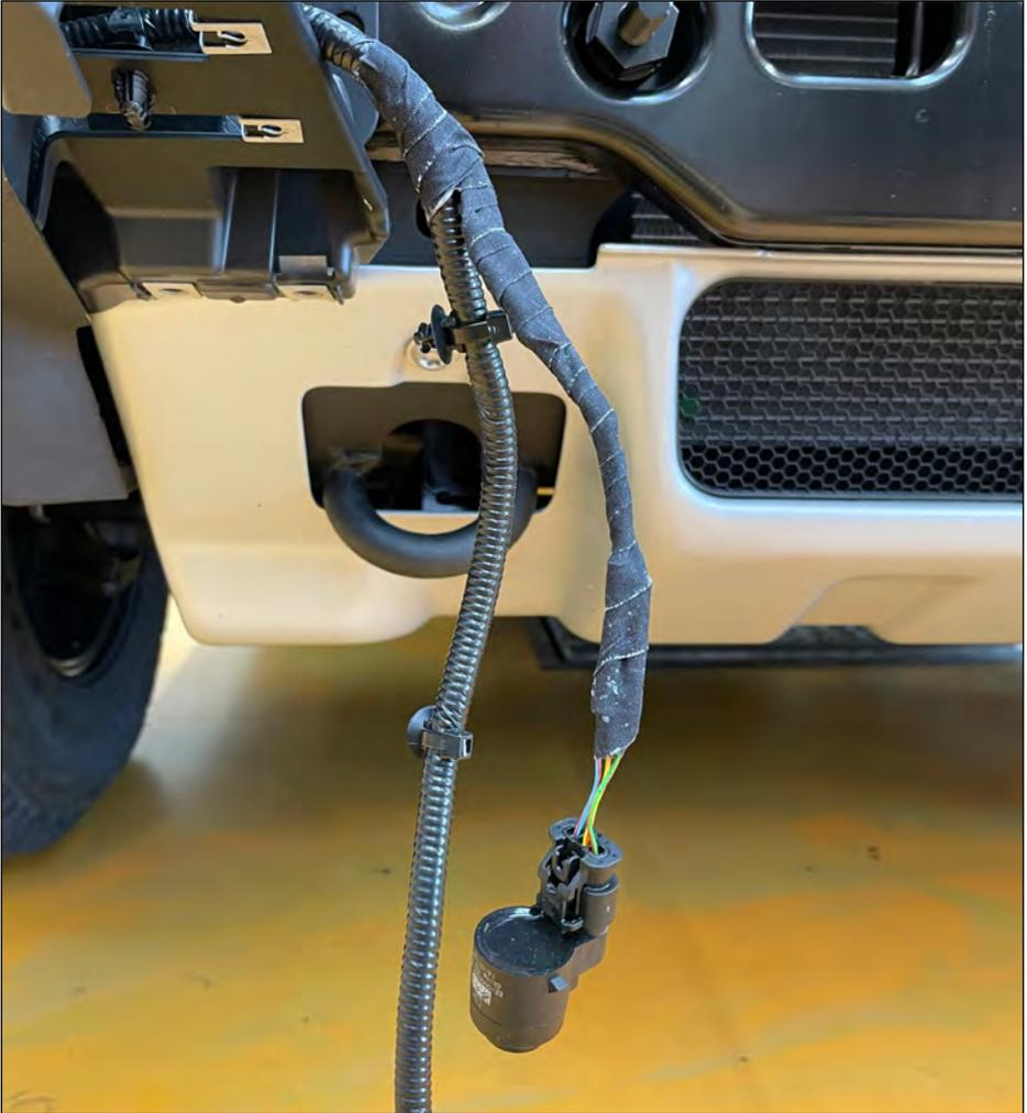
Kabel mit geeignetem Klebeband umwickeln.
