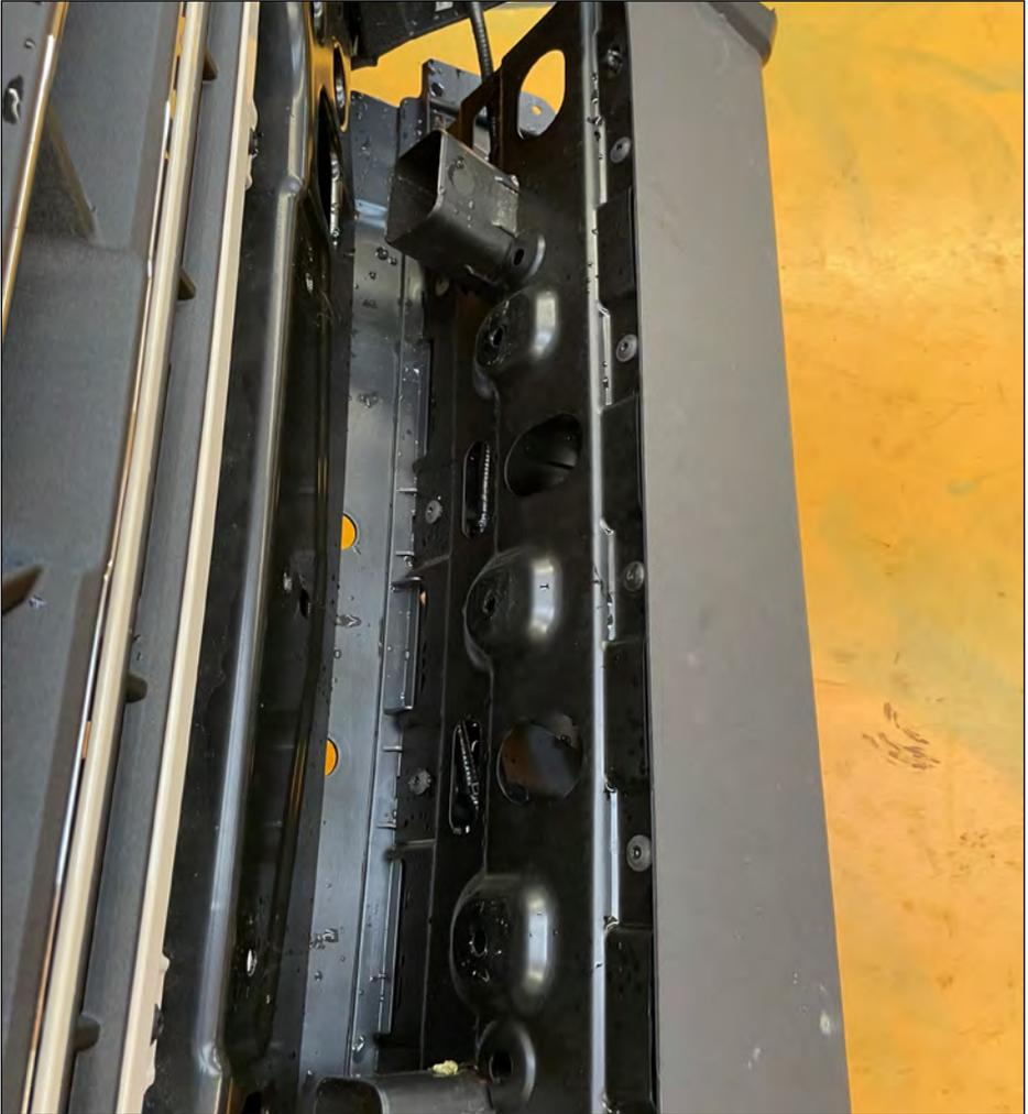
13 Torx Schrauben aus Rückseite von Mittelteil entfernen.
