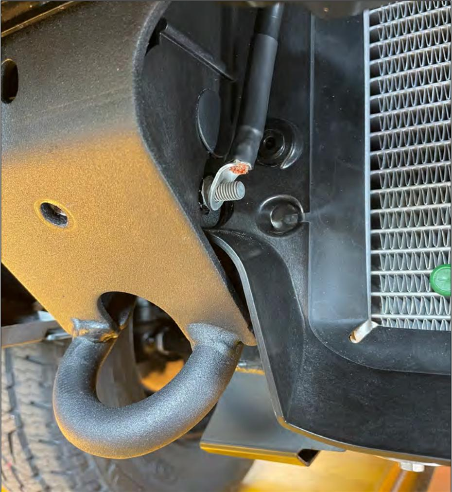
Massekabel zu Massepunkt ablängen. Auf Verlegung achten. Kabel locker führen.
