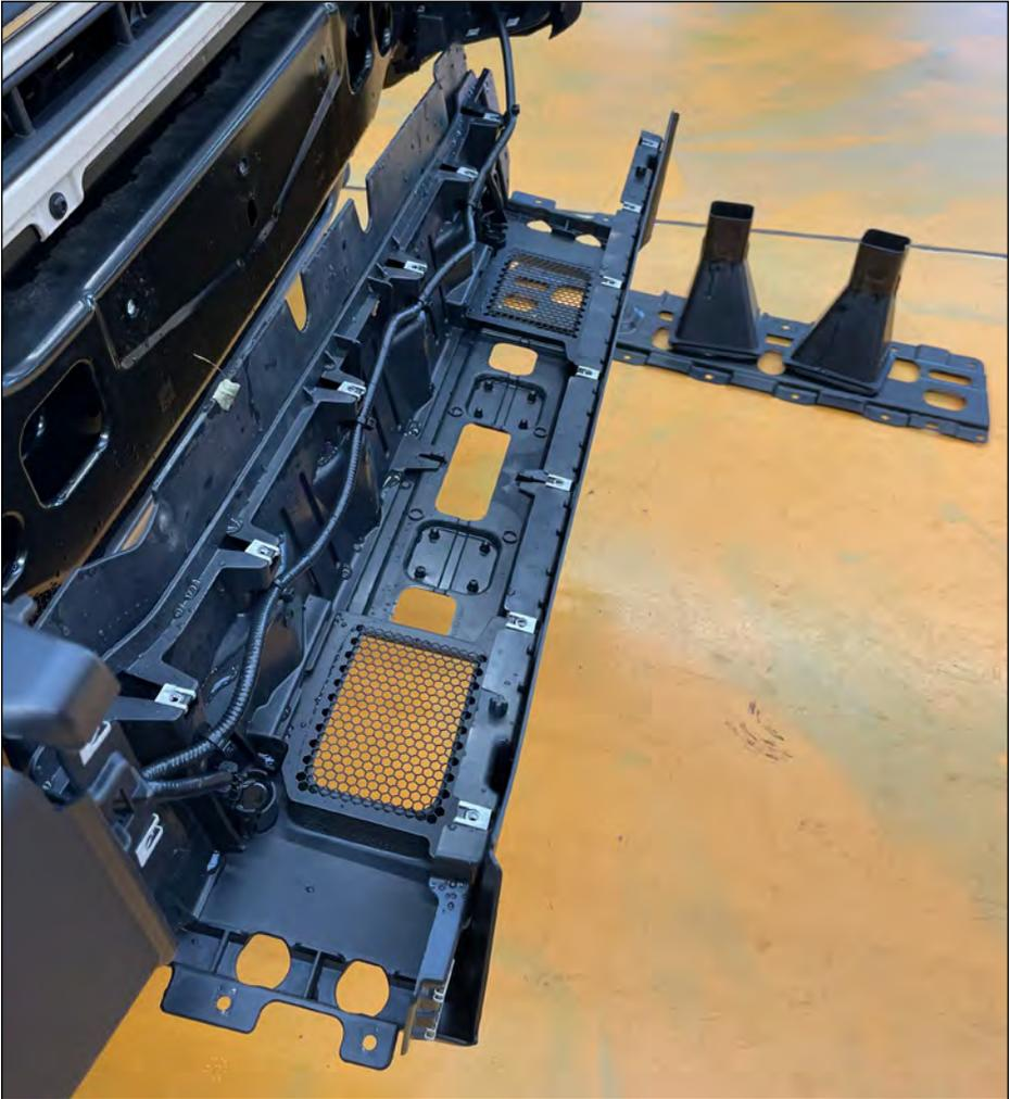
Metallplatte und die zwei darunterliegenden Kunststoffflutleiter herausnehmen.
