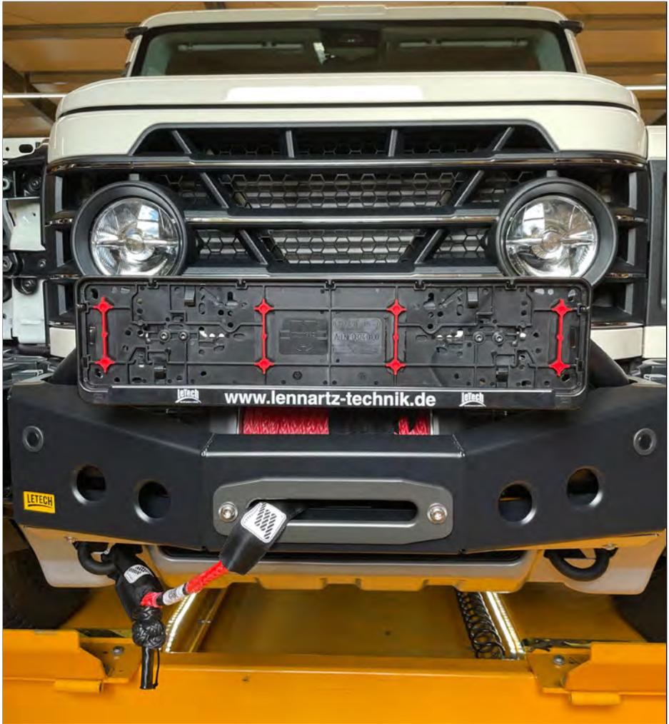
4x Kastenmütern einsetzen und Kennzeichenhalter festschrauben.
