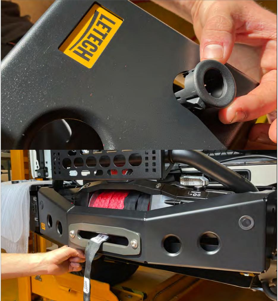
PDC Gehäuse einsetzen. PDC Sensoren in Blende einsetzen.
