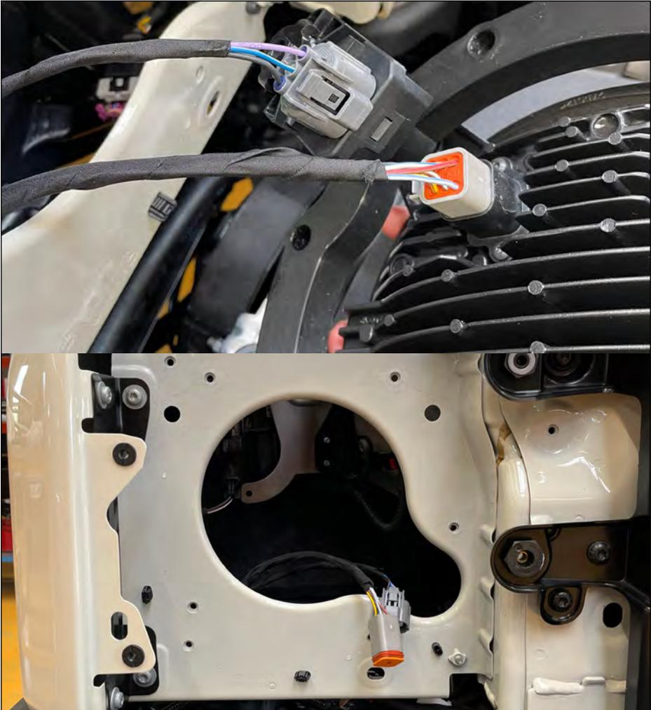
Scheinwerfer entfernen. Beide Stecker an Scheinwerfer ausstecken und Scheinwerfer beiseite legen.
