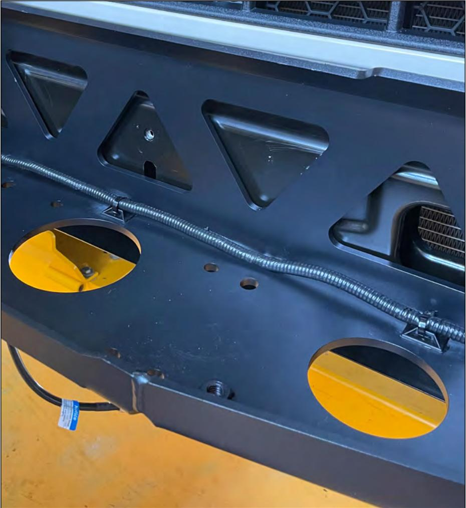
Kabelstrang mit geeignetem Befestigungsmaterial befestigen.
