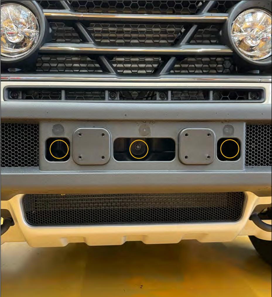
3 Torx Schrauben entfernen. Mittelteil leicht nach vorne ziehen.
