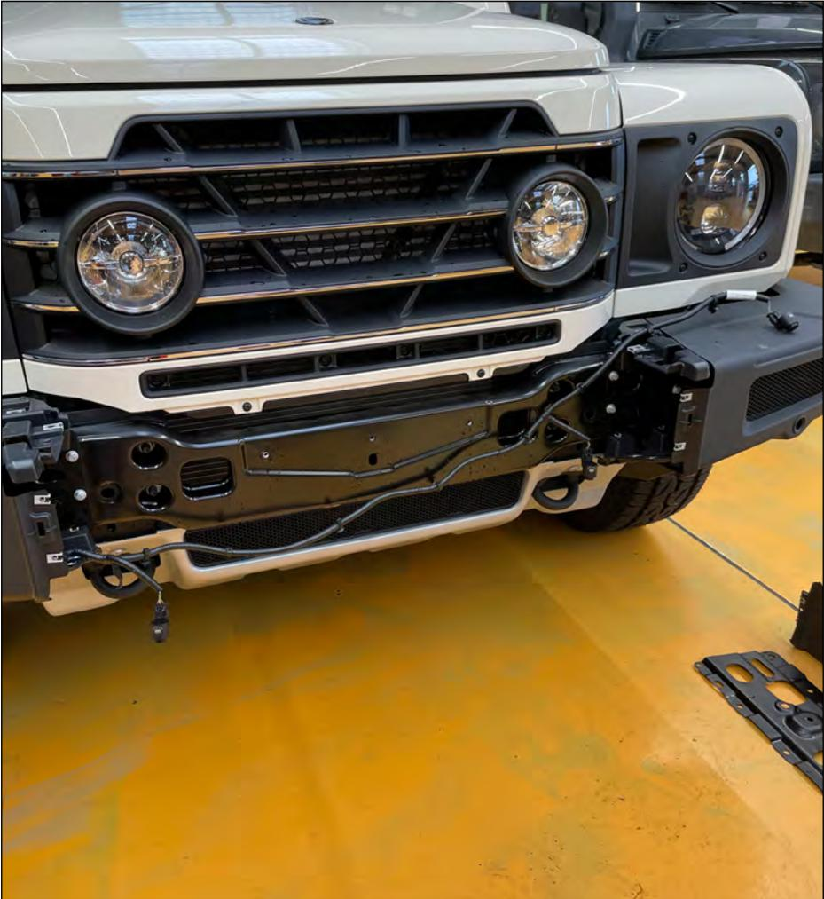
Mittelteil beiseite legen. Ummantlung der mittleren PDC-Sensoren entfernen.
