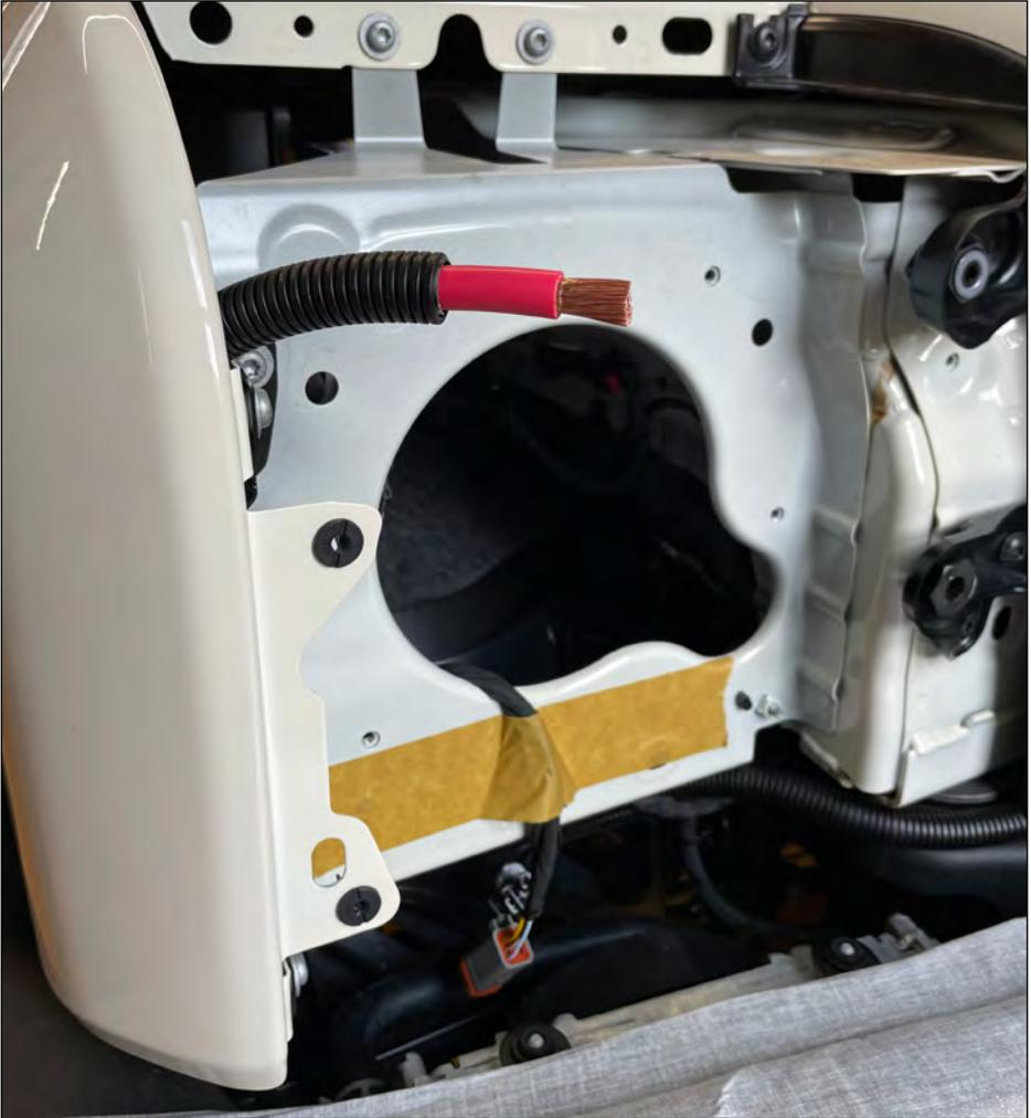
Kabel ablängen zu Verschraubpunkt von Relais.
