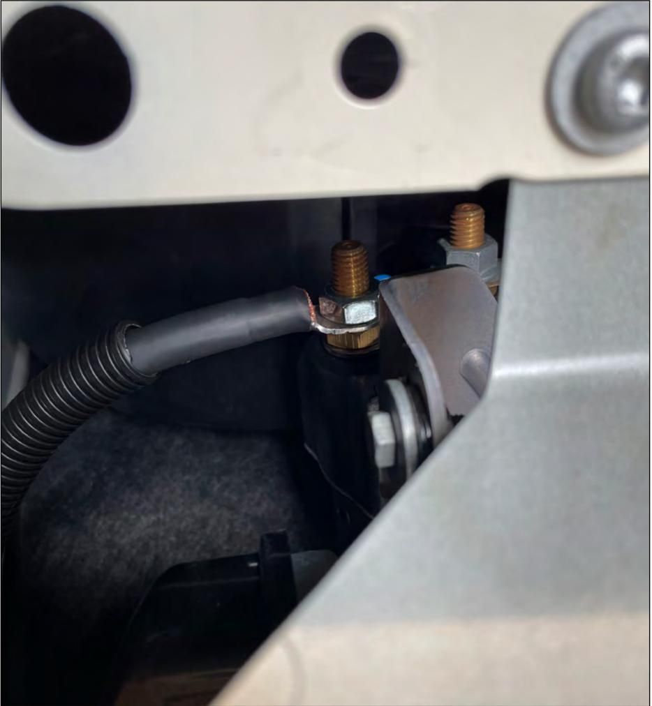
Kabelschuh mit Mutter M10 an Relais anbringen.
