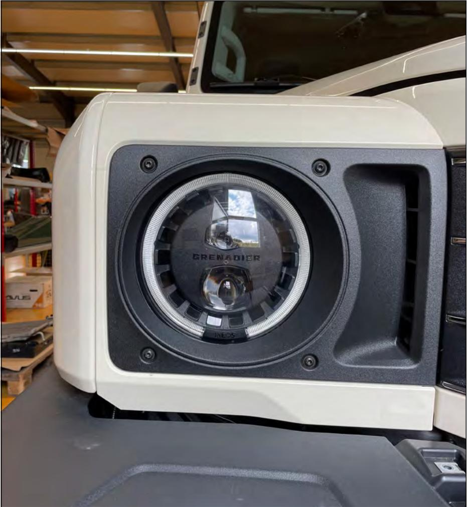
Scheinwerfer einstecken und einschrauben. Scheinwerferbefestigung und Scheinwerferblende montieren.
