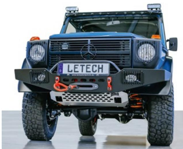
Seilwindenstossstange 460/461/463 bis MJ 2014 | Artikel-Nr.: 1039
