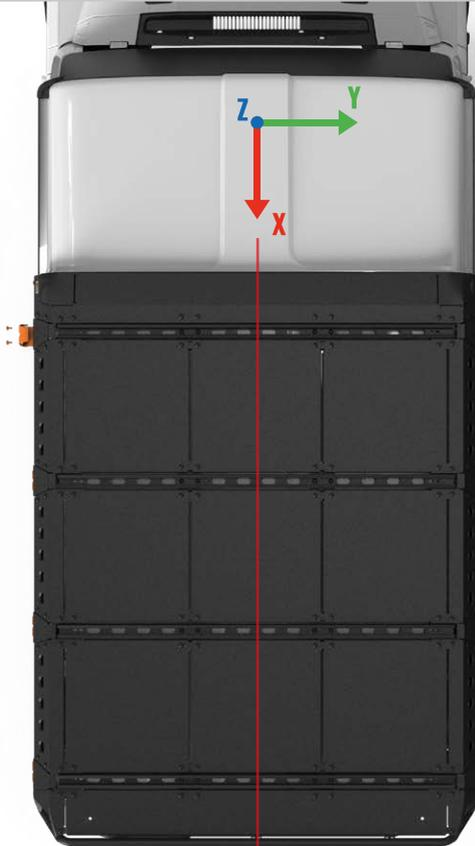
LeTech Dachträger so auf dem Dach vermitteln, dass die Dichtlippe vorne etwa 5mm Luft bis zur Phase des Daches hat.
