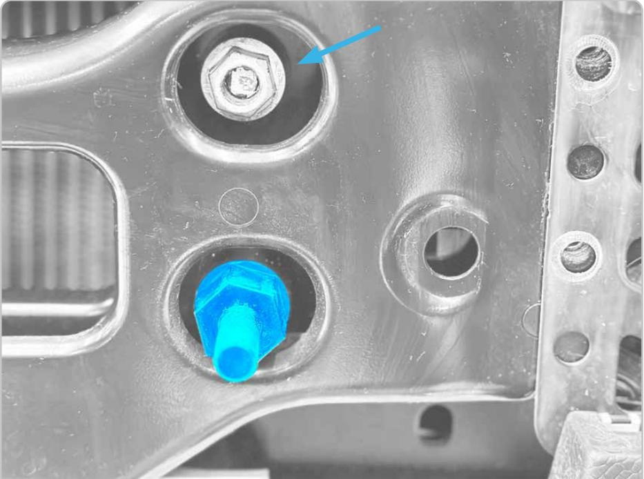
Die original Muttern durch die im Lieferumfang enthaltenen Gewindemuttern ersetzen und mit 85Nm anziehen.
