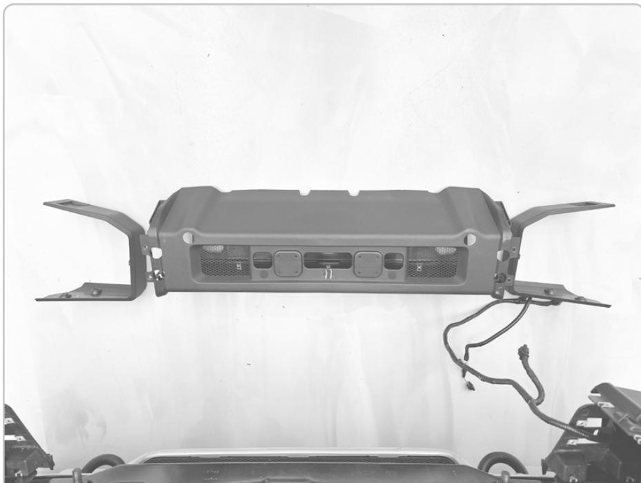
Das Mittelstück der Originalstoßstange herausnehmen und die Kabel ausstecken.
