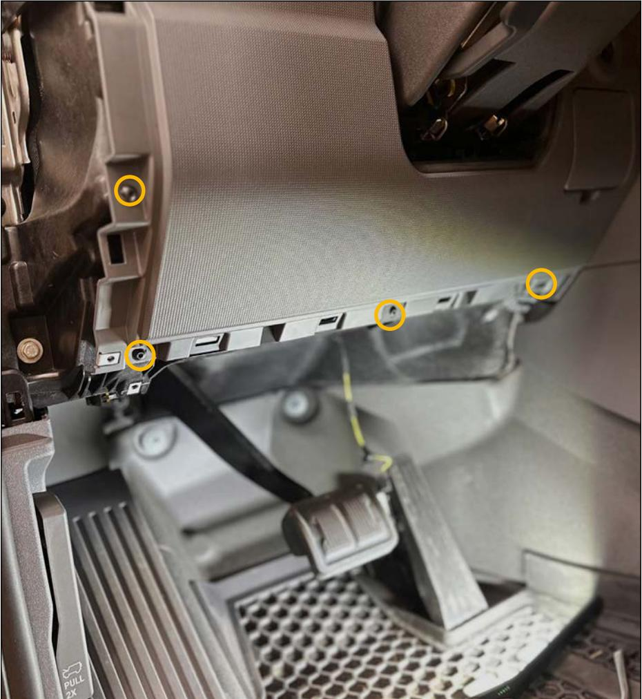
Seitliche Schraube sowie drei untere Schrauben mit Schraubendreher Tx20 lösen.
