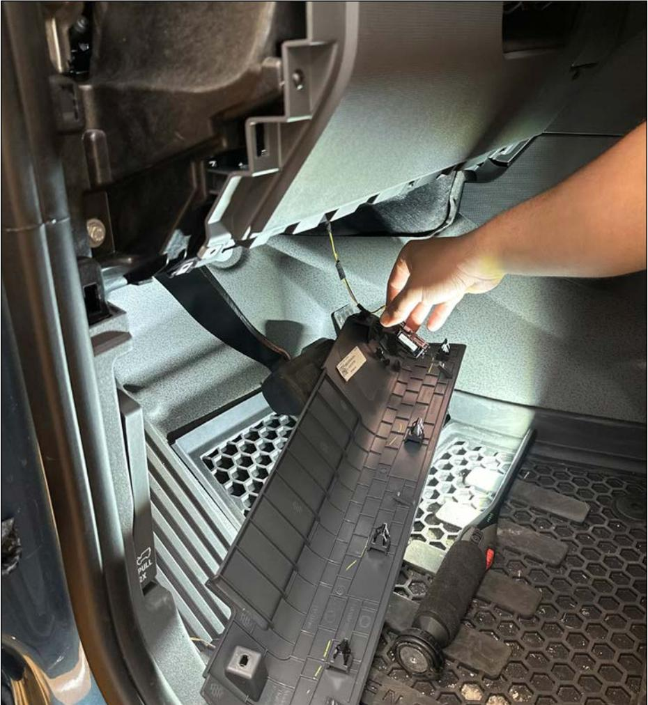
Fußraumbeleuchtung mithilfe von Klippheber ausklipsen (Klippkabelstrang abtrennen).
