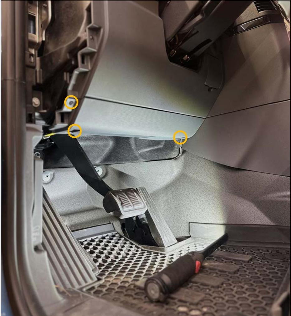
Seitliche und zwei untere Schrauben mit Schraubendreher Tx20 lösen.
