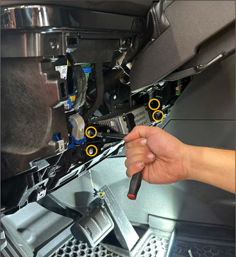
Vier Schrauben der Headunit mithilfe von Tx30 Rättsche lösen. Kabel der Headunit abstecken.
