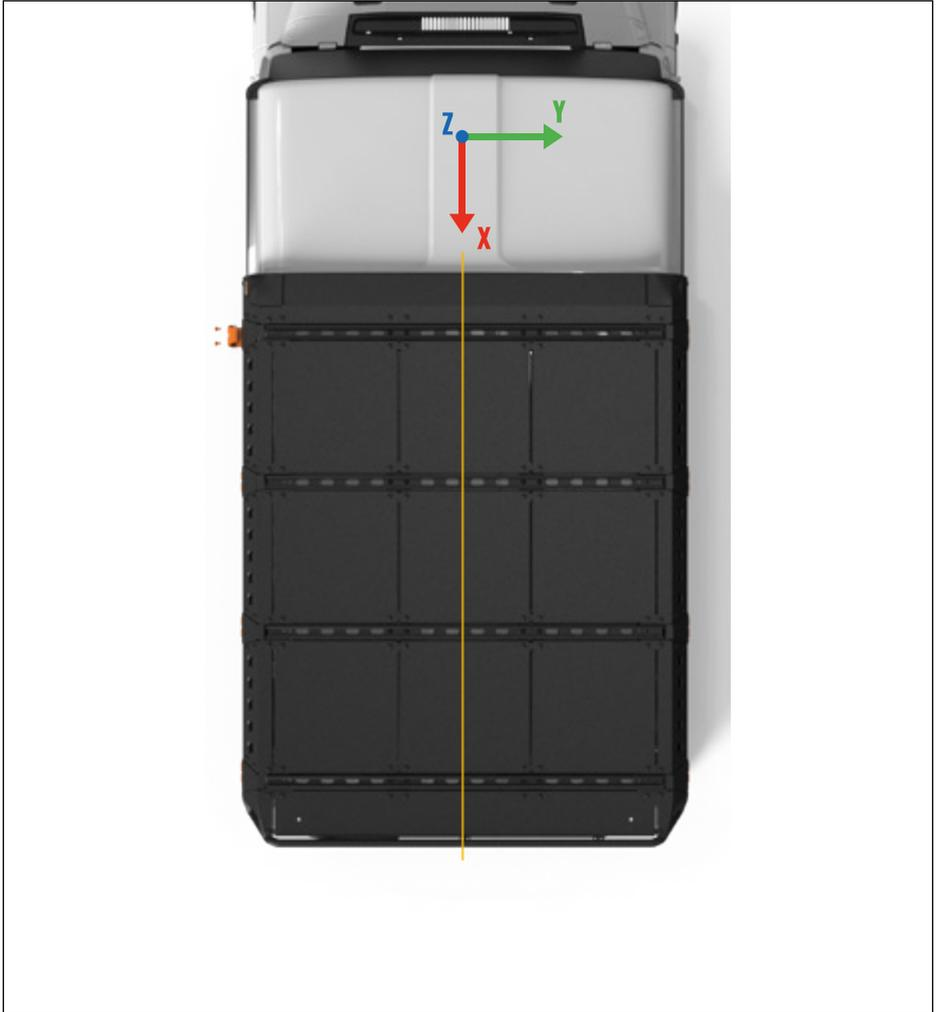
LETECH Dachträger so auf dem Dach vermitteln, dass die Dichtlippe vorne etwa 5mm Luft bis zur Phase des Daches hat.
