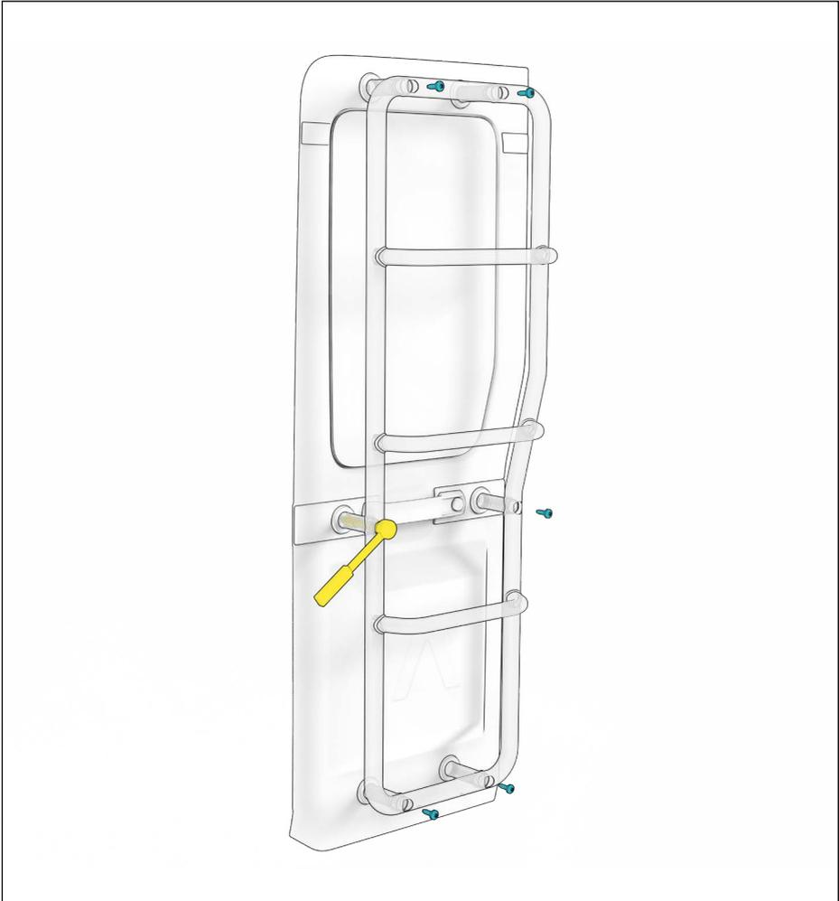
6x Schraube mit TX 40 Schlüssel herausdrehen.
