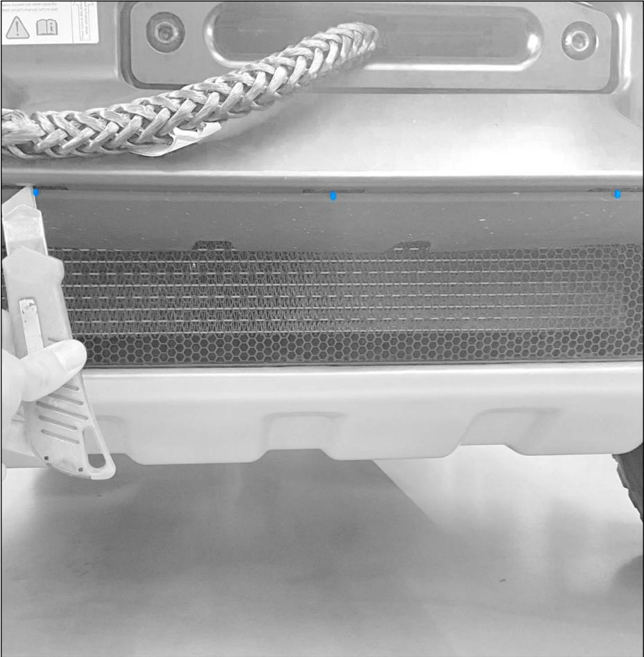
Die Angüsse in der Stoßstange mit einem geeigneten Werkzeug entfernen.
