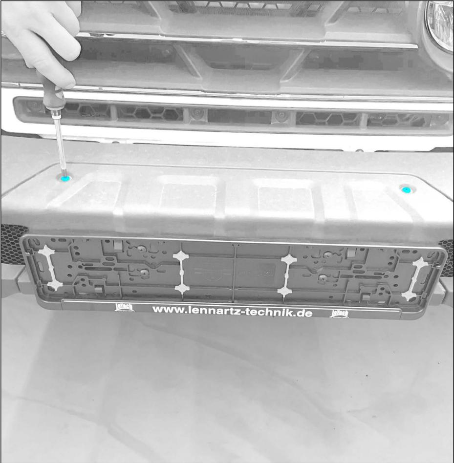
Die zwei Schrauben der Original Seilwindenabdeckung lösen und die Abdeckung aus der Stoßstange ausfahren.
