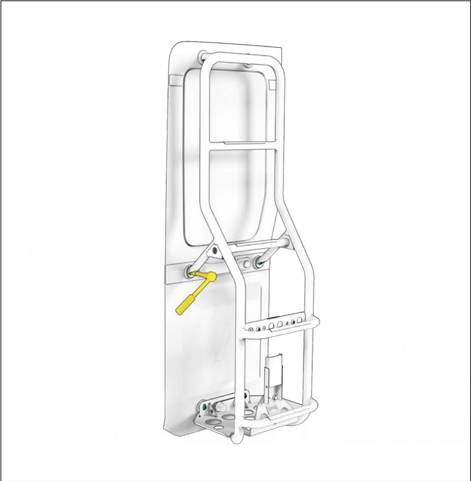
Die Schrauben mit Schraubensicherung „mittelfest“ versehen und mit einem 5mm Inbusschlüssel mit 15 Nm festziehen.
