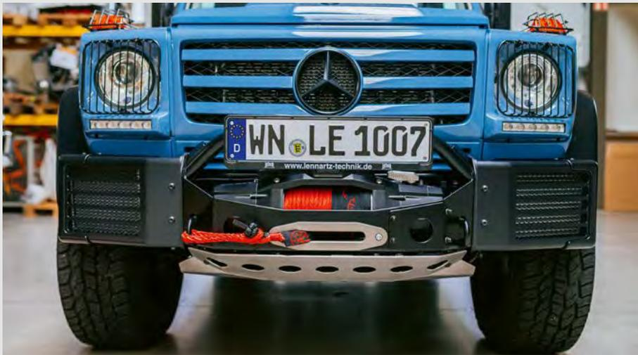
Der LETECH Seilwindenanbau für die G-Klasse ab MJ 2015 ermöglicht die stabile Montage der WARN Zeon-Seilwinde an der Fahrzeugfront. Die Seilwinde ist leicht zugänglich, schnell einsatzbereit und verfügt über ein 27 Meter Seil.
