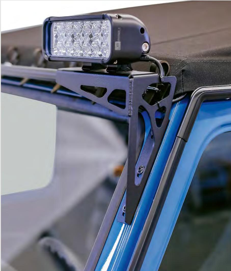
Der Scheinwerferbügel ist eine stabile Stahlkonstruktion zur einfachen Montage von Arbeitsscheinwerfern am 230 GE – ganz ohne Bohren. Nicht geeignet für 250/290 GD „Wolf“ mit Klappscheibe. Der „Ex-Schweizer“-Bügel bietet eine ideale Lösung für nächtliche Einsätze und Arbeiten bei schlechter Sicht.
