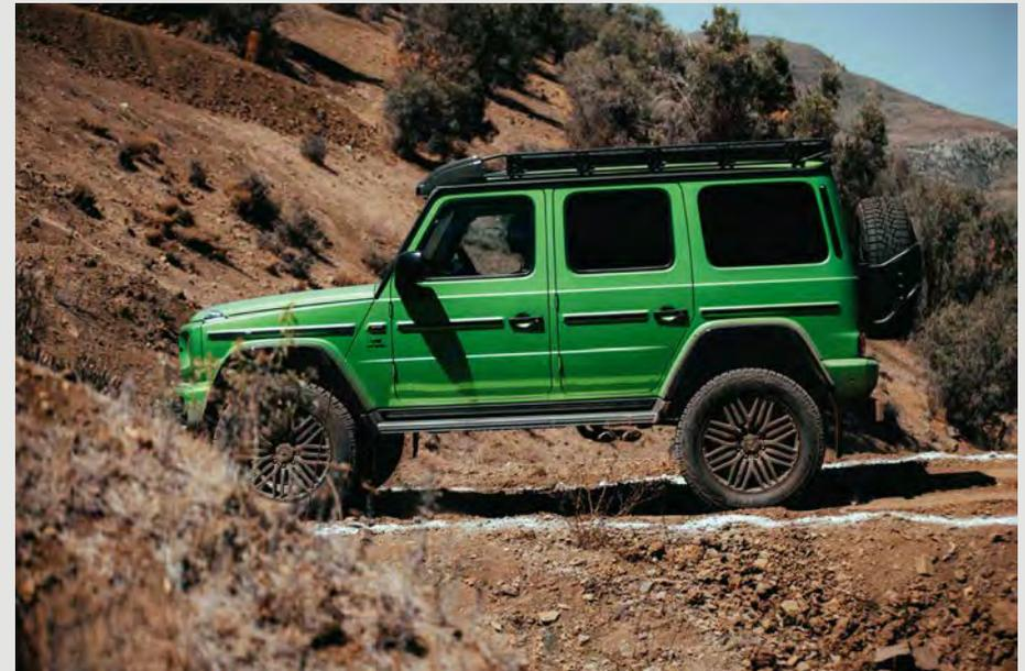
Durch die höhergelegte Achsbrücke wird der Freiraum zwischen den angetriebenen Rädern vergrößert, sodass Hindernisse selbst in schwierigstem Terrain sicher überwunden werden können. In Kombination mit dem Central Tire Inflation System (CTIS) profitieren Fahrer von erhöhtem Fahrkomfort bei Schlechtwegen und in Situationen bei denen maximale Traktion gefordert ist (Schnee, Sand, Schlamm), da der Luftdruck bequem während der Fahrt geändert werden kann.
