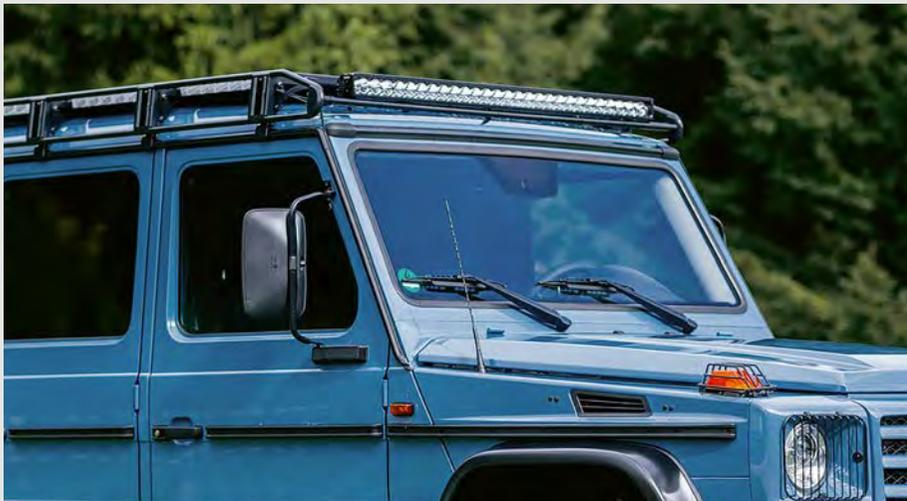
Die VISION X 51" LED-Lightbar (ca. 1.300 mm) verfügt über 27 Hochleistungs-LEDs mit je 10 Watt und erzeugt 20.393 Lumen bei einem Abstrahlwinkel von 5°. Das staub- und wasserdichte Aluminiumgehäuse ist durch eine kratzfesten Polycarbonatscheibe geschützt.
