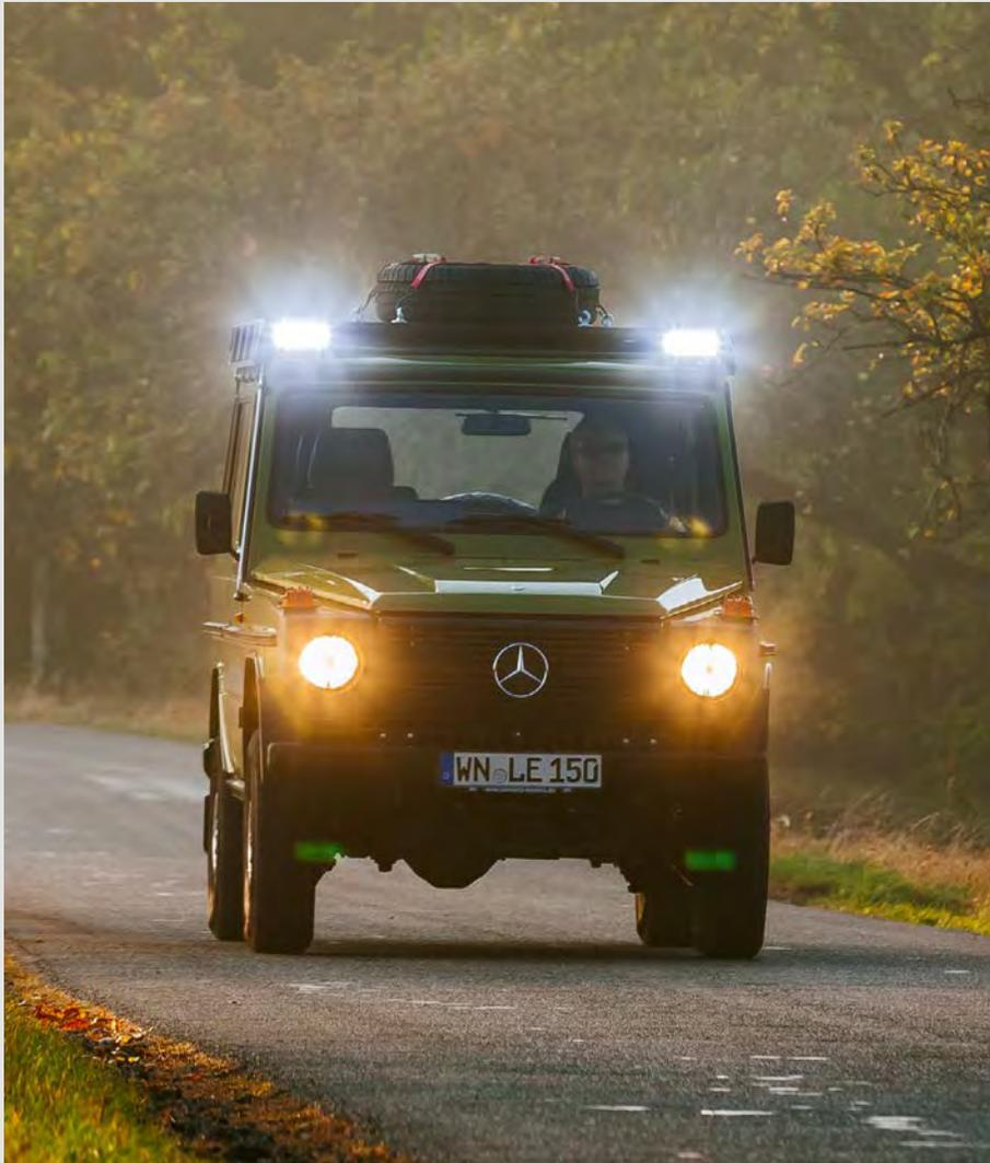
Der Scheinwerferbügel ermöglicht die sichere Montage zusätzlicher Scheinwerfer vorne am Dachträger - für die G-Klasse vor Modelljahr 2018. Passend für die 51" LED Lightbar oder Abeitsscheinwerfer. Hergestellt aus Stahl und durch eine KTL- und Pulverbeschichtung perfekt vor Korrosion geschützt.
