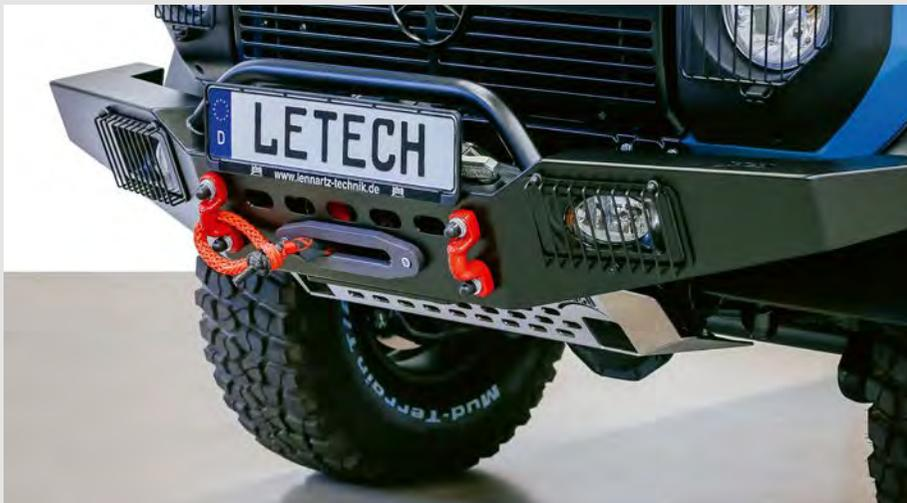
Die LETCH Seilwindenstoßstange für die G-Klasse bis MJ 2014 ist ein robuster Windenträger aus hochwertigem Stahl zur Montage elektrischer Seilwinden, einschließlich der Warn ZEON Serie.
