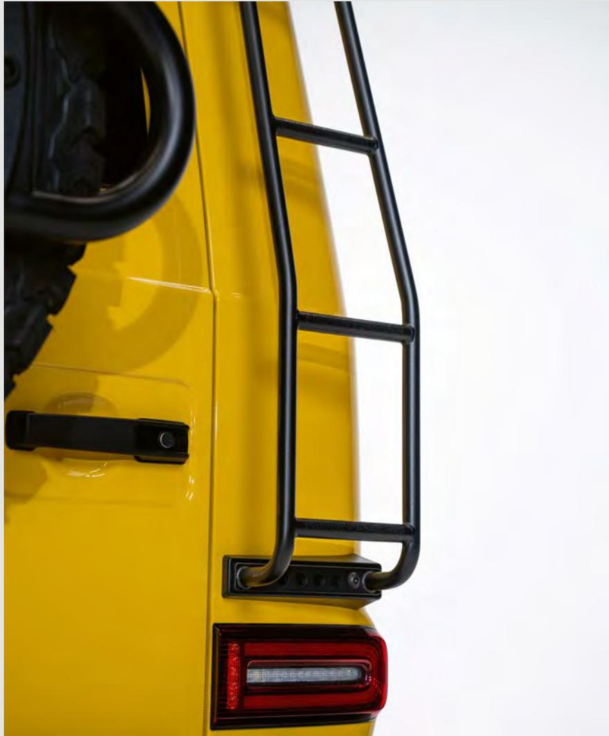
Die LETCH Heckleiter ermöglicht den sicheren Zugang zum Fahrzeugdach. Die Befestigung erfolgt oben durch eine direkte Verschraubung am Dachträger, während unten eine Halteplatte für sicheren und festen Halt sorgt. Diese wird am Karosserieblech verklebt, was Korrosion verhindert und eine Demontage ermöglicht. Sie ist aus hochwertigem Stahl gefertigt, sowie KTL- und pulverbeschichtet.
