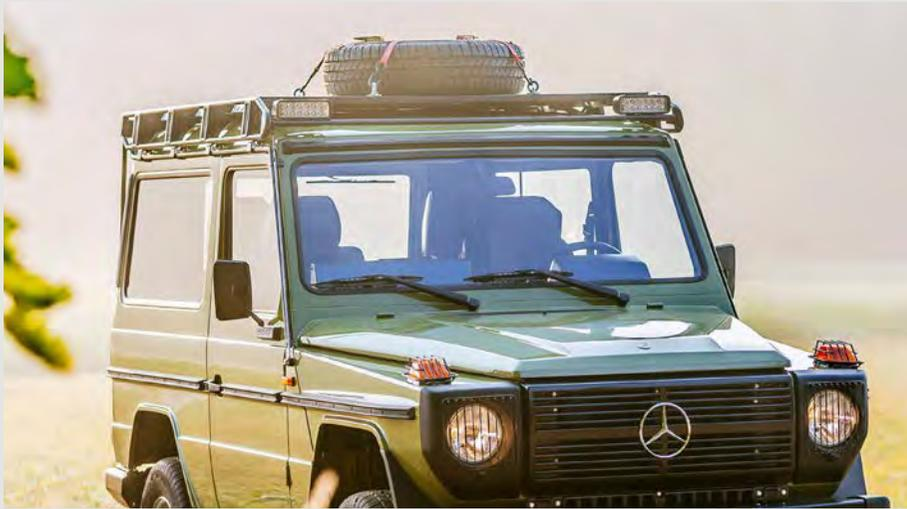
Die Arbeitsscheinwerfer von VISION X verfügen über 12 leistungsstarke 3-Watt-LEDs in zwei Reihen. Das staub- und wasserdichte Aluminiumgehäuse (IP68) mit kratzfesten Polycarbonatscheibe bietet robusten Schutz. Der Strahler liefert 1.188 Lumen bei 36 Watt Leistung.
